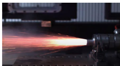
Combustia noilor compozite în motor rachetă
