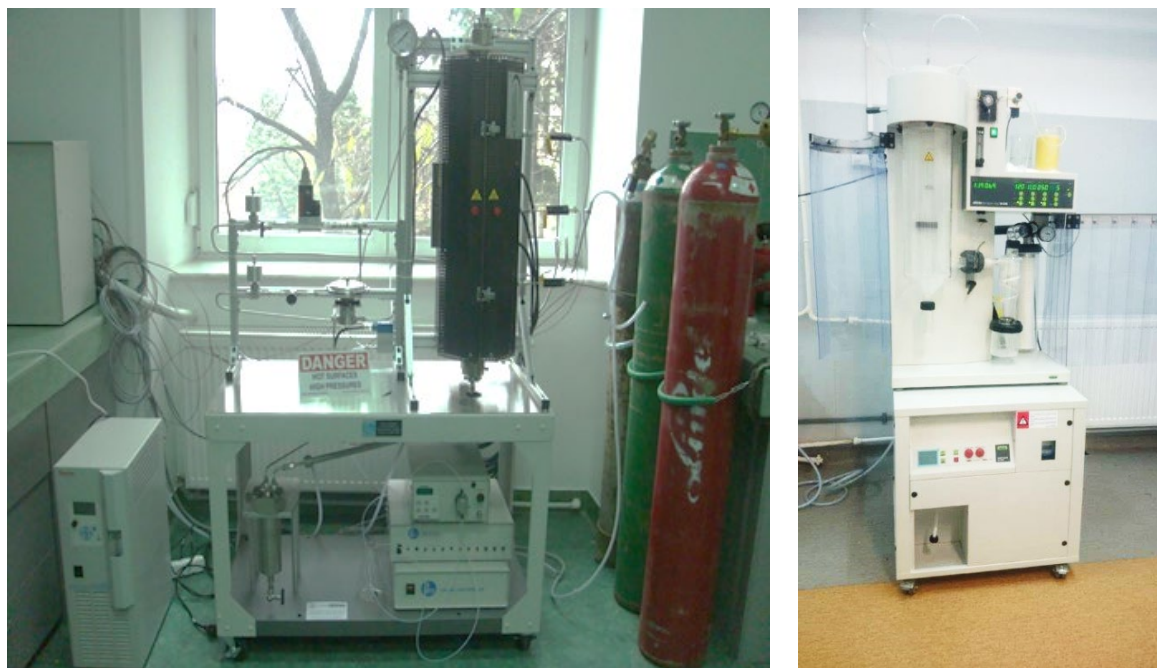
Fig. 6.2. Reactorul tubular Parr (a) și nano-atomizorul Buchi (b), din componența Centrului de cercetări avansate pentru bionanotehnologii - BioNAN, care prezintă caracteristici de unicatitate la nivel național, datorită integrării într-o infrastructură cu flexibilitate ridicată, necesară atât și (bio)proceselor de valorificare "inteligentă" a biomasei, cât și pentru realizarea de inputuri inovative pentru producerea resurselor biologice.
