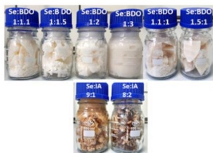
Exantioane de bioelastomeri de tipul poli(butilensebacatilor) și copolimeri de tipul poli(butilen sebacat-co-propilen itaconat) obținuți din resurse regenerabile
