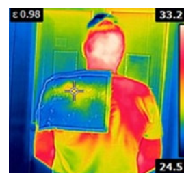
Camuflaj tip “pădure” pentru materiale textile cu efect de atenuare a amprentei termice
