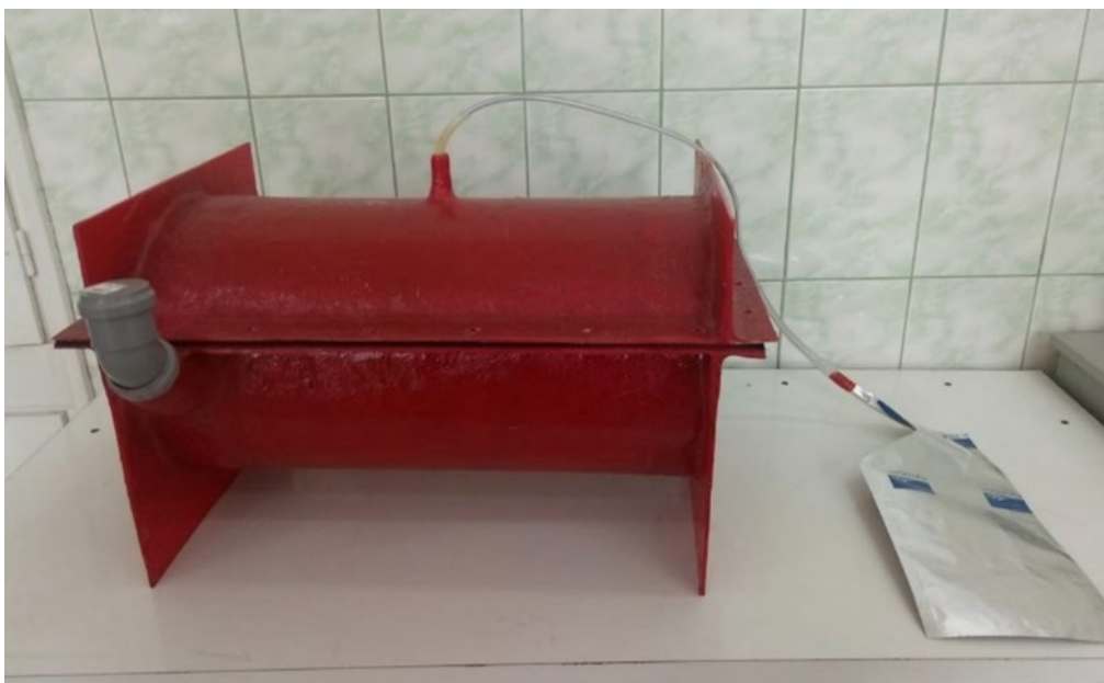
Fig. 6.5. Instalație experimentală de digestie anaerobă - 30L.
