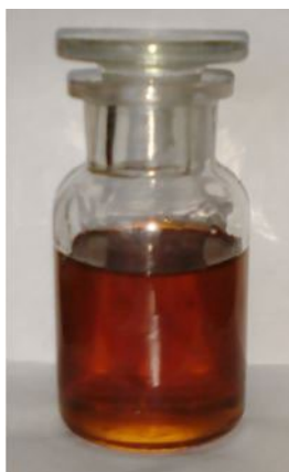
Flacon de 100 ml conținând polioli oligomeri pentru spume poliuretanică rigide obținuți din deșeurile de PET și monomeri provenind din resurse regenerabile
