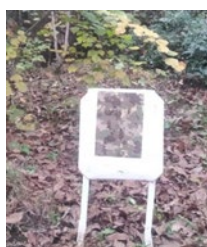
Camuflaj tip “pădure” pentru materiale textile cu efect de atenuare a amprentei termice
