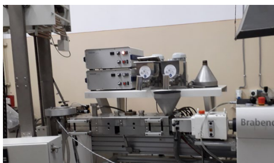
Instalație de extrudare-suflare folii (stânga); Folie suflata din proba PHB/PHO/MC (dreapta)
