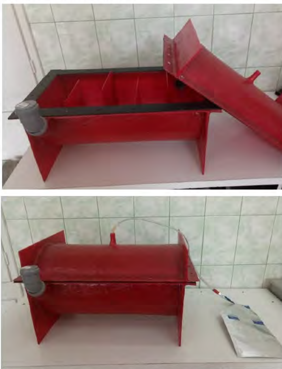
Fig. 6.5. Instalație experimentală de digestie anaeroba - 30L.
