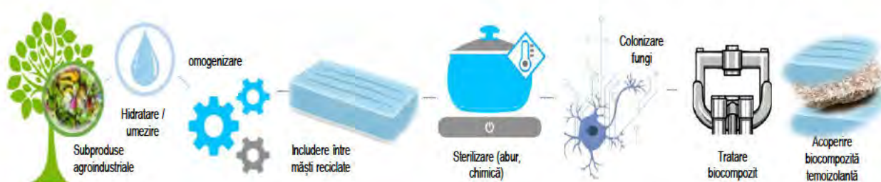
Fig. 6.12. Ilustrarea proiectului COVertin, prin care se valorifică într-un biomaterial inovativ subprodusele agroindustriale și măștile de protecție reciclate.
