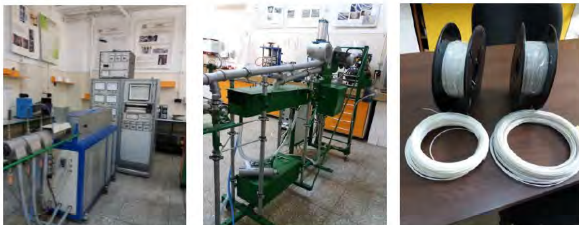
Fig. 6.8. Prototip pentru obținerea filamentelor polimerice pentru imprimarea 3D/4D
